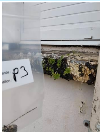
Matériaux : Z07 - Facades - Appuie fenêtre - Enduit + peinture Prélèvement : P003 Description : enduit + peinture Localisation : BAT 4 - Façade avant gauche - Appuie fenêtre Résultat : Absence d'amiante
