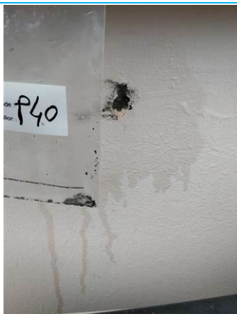
Matériaux : Z08 - Façades - Mur - Enduit + peinture Prélèvement : P040 Description : enduit + peinture Localisation : BAT 4 - Façade arrière droite - Mur haut Résultat : Absence d'amiante
