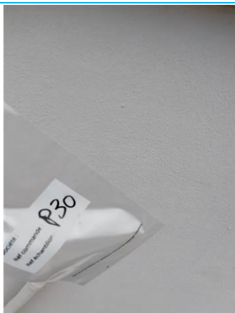
Matériaux : Z08 - Façades - Mur - Enduit + peinture Prélèvement : P030 Description : enduit + peinture Localisation : BAT 4 - Façade arrière gauche - Mur haut Résultat : Absence d'amiante
