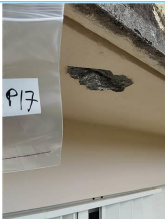
Matériaux : Z06 - Façades - Sous face casquette - Enduit + peinture Prélèvement : P017 Description : enduit + peinture Localisation : BAT 4 - Façade avant droite - Sous face casquette Résultat : Absence d'amiante
