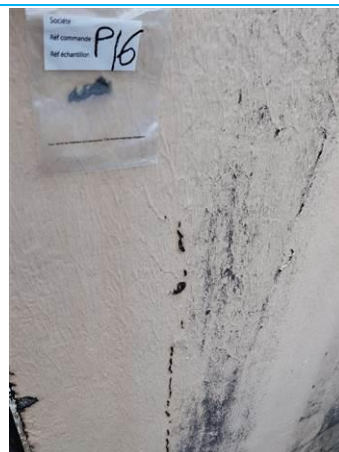
Matériaux : Z01 - Pignons - Mur haut - enduit + peinture Prélèvement : P016 Description : enduit + peinture Localisation : BAT 4 - 1er pignon - Mur bas Résultat : Absence d'amiante
