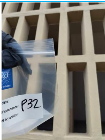
Matériaux : Z03 - Façades - Élément préfabriqué - Enduit + peinture Prélèvement : P032 Description : enduit + peinture Localisation : BAT 4 - Façade arrière gauche - Élément préfabriqué Résultat : Absence d'amiante
