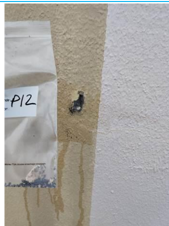
Matériaux : Z01 - Pignons - Mur haut - enduit + peinture Prélèvement : P012 Description : enduit + peinture Localisation : BAT 4 - 2eme pignon - Mur milieu Résultat : Absence d'amiante
