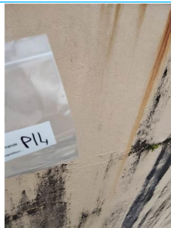
Matériaux : Z01 - Pignons - Mur haut - enduit + peinture Prélèvement : P014 Description : enduit + peinture Localisation : BAT 4 - 1er pignon - Mur haut Résultat : Absence d'amiante
