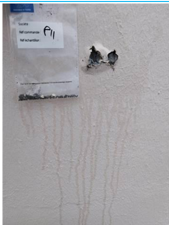
Matériaux : Z01 - Pignons - Mur haut - enduit + peinture Prélèvement : P011 Description : enduit + peinture Localisation : BAT 4 - 2eme pignon - Mur Haut Résultat : Absence d'amiante
