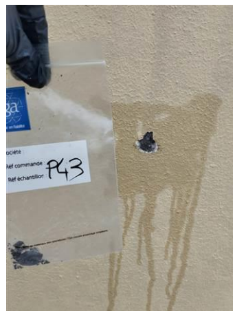
Matériaux : Z08 - Façades - Mur - Enduit + peinture Prélèvement : P043 Description : enduit + peinture Localisation : BAT 4 - Façade arrière droite - Mur cage escalier Résultat : Absence d'amiante
