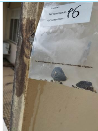
Matériaux : Z09 - Façades - Tranche - Enduit + peinture Prélèvement : P006 Description : enduit + peinture Localisation : BAT 4 - Façade avant gauche - Tranche Résultat : Absence d'amiante
