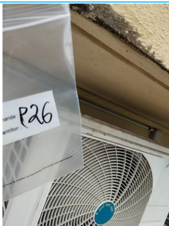
Matériaux : Z02 - Façades - Sous face balcon - Enduit + peinture Prélèvement : P026 Description : enduit + peinture Localisation : BAT 4 - Façade avant droite - sous face balcon Résultat : Absence d'amiante
