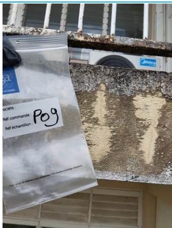
Matériaux : Z09 - Façades - Tranche - Enduit + peinture Prélèvement : P009 Description : enduit + peinture Localisation : BAT 4 - Façade avant gauche - Tranche horizontale Résultat : Absence d'amiante
