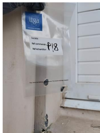
Matériaux : Z04 - Pignons, Façades - Embrasure fenêtre - Enduit + peinture Prélèvement : P018 Description : enduit + peinture Localisation : BAT 4 - Façade avant droite - Embrasure fenêtre Résultat : Absence d'amiante
