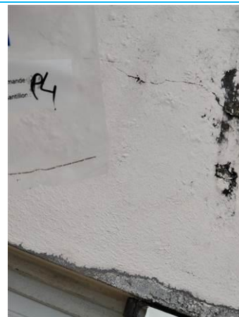
Matériaux : Z08 - Façades - Mur - Enduit + peinture Prélèvement : P004 Description : enduit + peinture Localisation : BAT 4 - Façade avant gauche - Mur haut Résultat : Absence d'amiante
