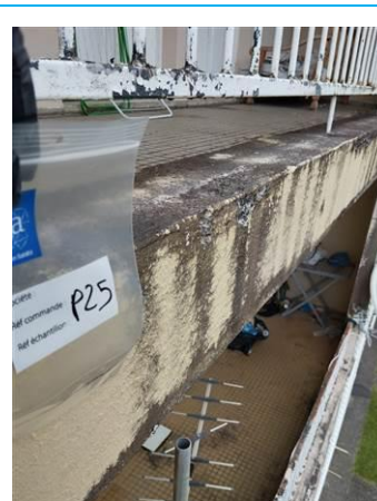
Matériaux : Z09 - Façades - Tranche - Enduit + peinture Prélèvement : P025 Description : enduit + peinture Localisation : BAT 4 - Façade avant droite - Tranche horizontale Résultat : Absence d'amiante
