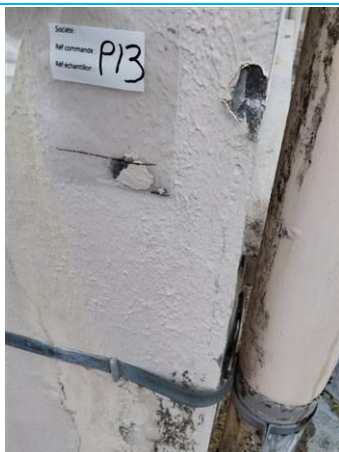
Matériaux : Z01 - Pignons - Mur haut - enduit + peinture Prélèvement : P013 Description : enduit + peinture Localisation : BAT 4 - 2eme pignon - Mur bas Résultat : Absence d'amiante
