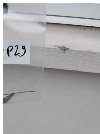
Matériaux : Z07 - Façades - Appuie fenêtre - Enduit + peinture Prélèvement : P029 Description : enduit + peinture Localisation : BAT 4 - Façade arrière gauche - Appuie fenêtre Résultat : Absence d'amiante
