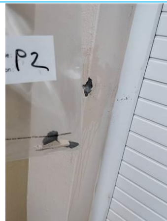
Matériaux : Z04 - Pignons, Façades - Embrasure fenêtre - Enduit + peinture Prélèvement : P002 Description : enduit + peinture Localisation : BAT 4 - Façade avant gauche - Embrasure fenêtre Résultat : Absence d'amiante
