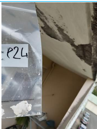
Matériaux : Z10 - Façades - Plafond de balcon - Enduit + peinture Prélèvement : P024 Description : enduit + peinture Localisation : BAT 4 - Façade avant droite - Plafond balcon Résultat : Absence d'amiante
