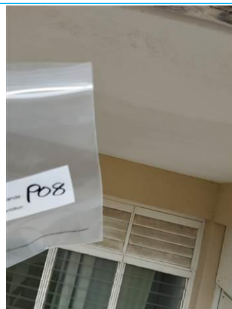
Matériaux : Z10 - Façades - Plafond de balcon - Enduit + peinture Prélèvement : P008 Description : enduit + peinture Localisation : BAT 4 - Façade avant gauche - Plafond balcon Résultat : Absence d'amiante
