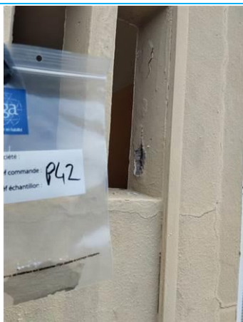
Matériaux : Z03 - Façades - Element préfabriqué - Enduit + peinture Prélèvement : P042 Description : enduit + peinture Localisation : BAT 4 - Façade arrière droite - Elément préfabriqué Résultat : Absence d'amiante
